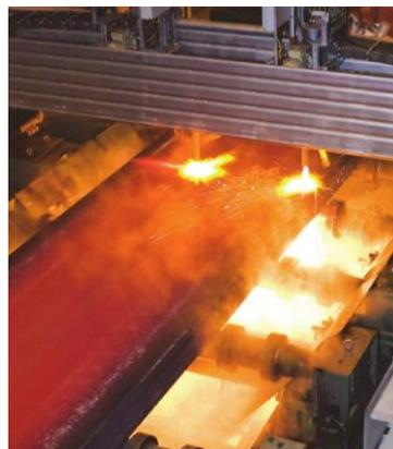
Рисунок 7 – Газовая резка непрерывнолитого слитка
