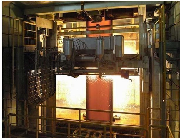
Рисунок 12 – разрезание сляба на вертикальной МНЛЗ
