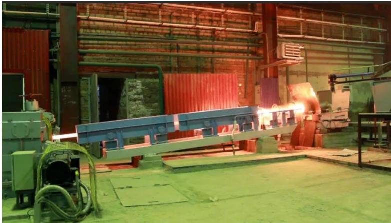
Рисунок 17 – технологическая ось горизонтальной МНЛЗ
