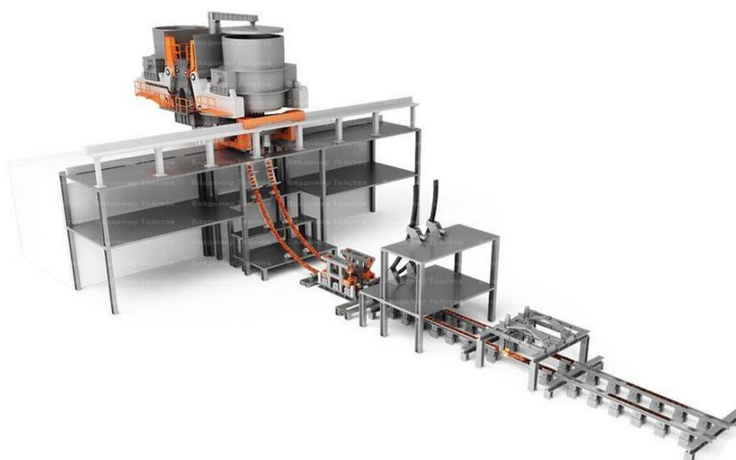
Рисунок 14 – модель криволинейной МНЛЗ
