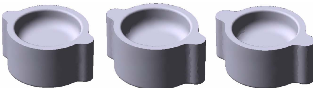
Рис.5. Поковка без дефектов, полученная в три перехода
