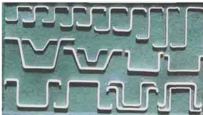
Рис.3 Профили с покрытиями, применяющиеся в авиастроении (стрингеры)
