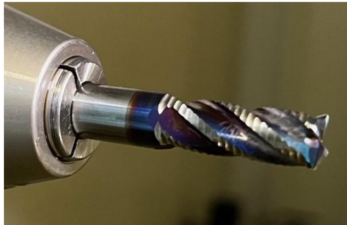
Рис. 1. Концевая фреза с вышлифованными стружкоделительными канавками для черновой обработки заготовок из алюминиевых сплавов
