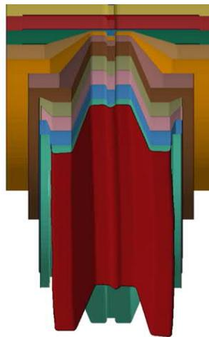
Рис. 2. Исследование получения профиля ПШ 115-45 методом конечных элементов
