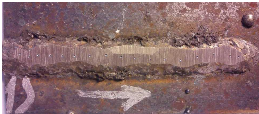
Рис. 5. Образец во время замера твердости
