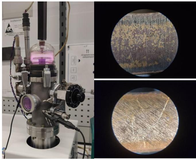
Рис. 1. Внешний вид реактора и результат травления меди ( $P_{Ar} = 0,8$  Торр,  $U = 515$  В)
