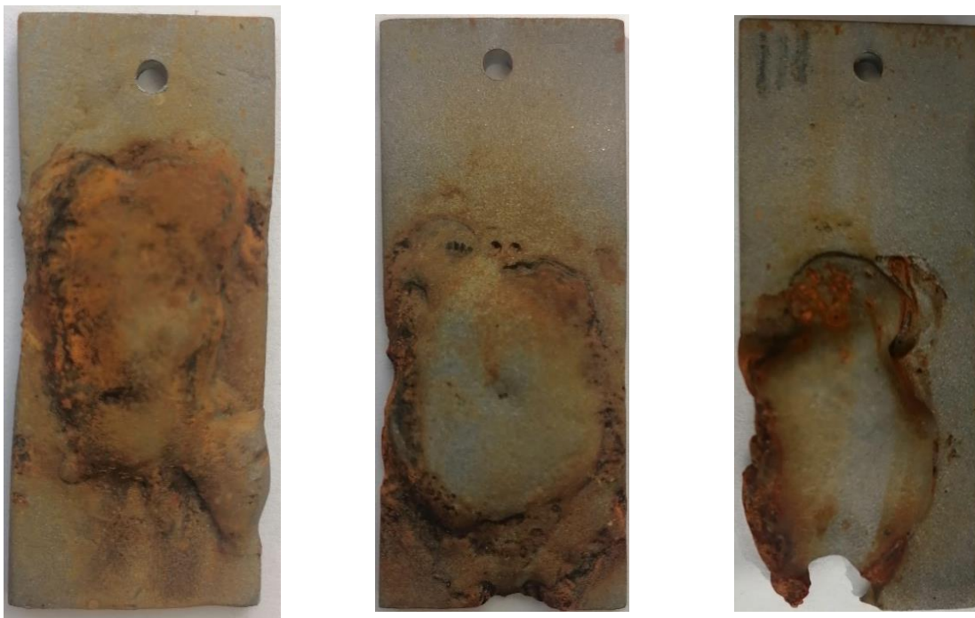
Рисунок 1 – Образцы с покрытиями, после эксперимента со следами коррозии
