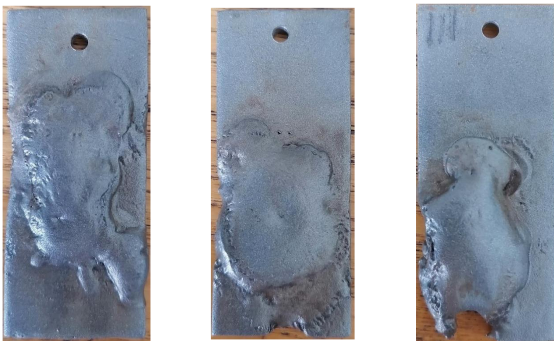
Рисунок 2 – Образцы с покрытиями, после удаления следов коррозии после эксперимента
