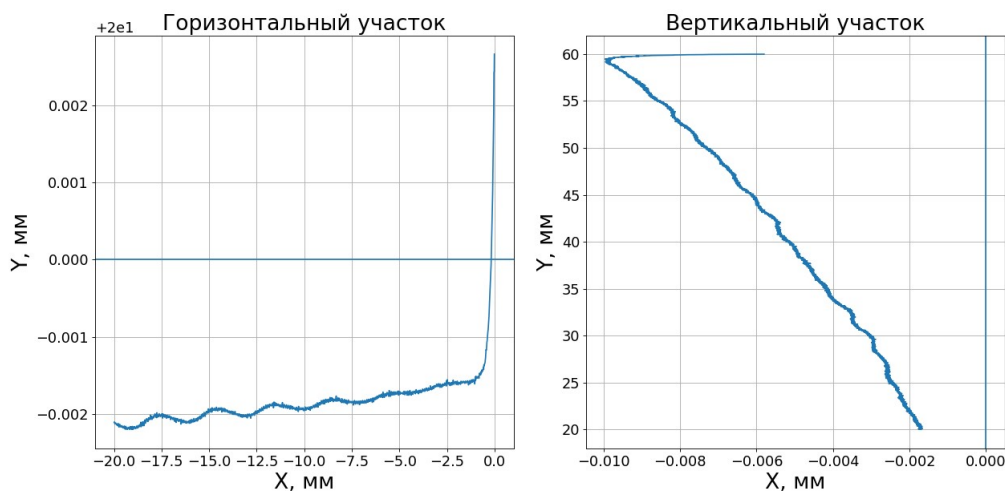
Рисунок 1 – Положение рабочего органа при движении вдоль одной из осей станка
