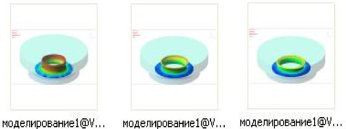
Рис. 10. Потеря устойчивости верхней части трубы
