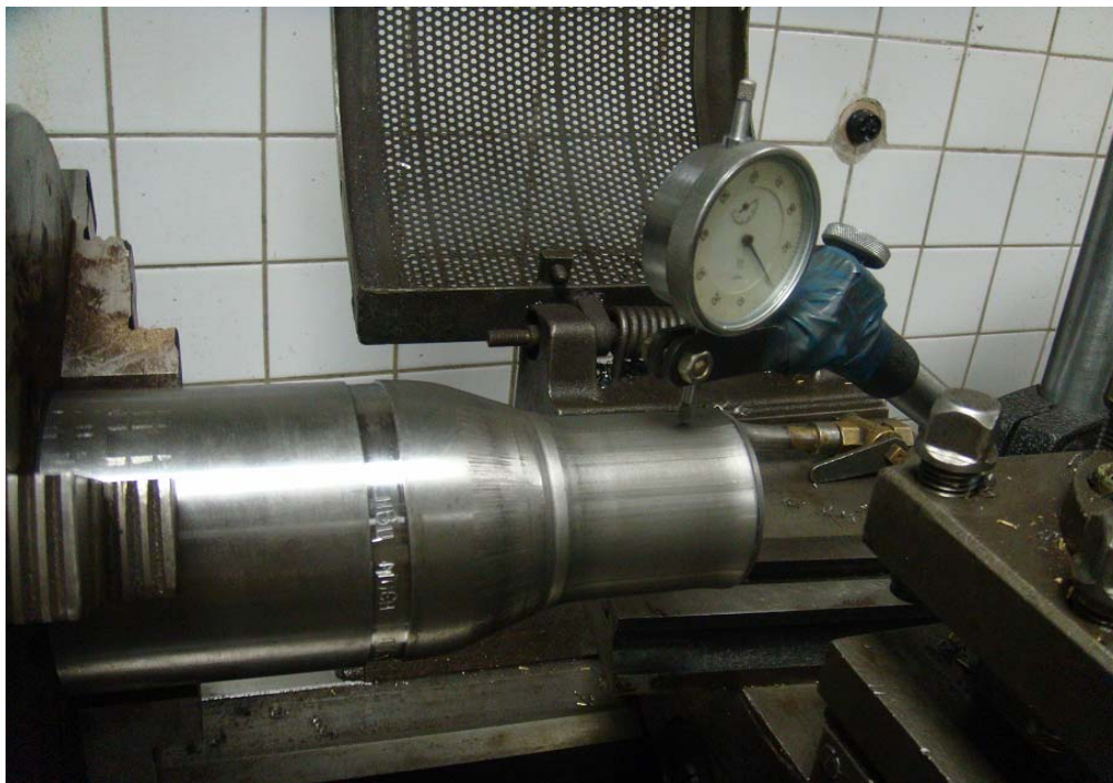
Рис. 2. Измерение диаметрального биения.
