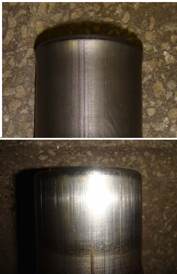
Рис. 10. Хвостовая часть поковки до и после правки.
