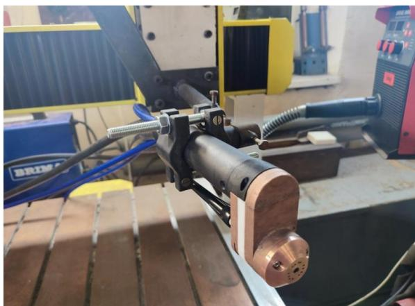
Рис. 2. Модернизированный плазмотрон на автоматизированной установке для упрочнения рабочих органов
