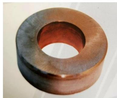
Рис. 2 Деформирующая фильера с РМР поверхности рабочего канала, полностью покрытая «сервовитной» пленкой после волочения в среде металлоплакирующей смазки.
