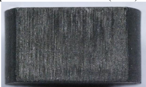
Рис. 1. Боковая поверхность реза синтетического алмаза толщиной 4 мм (параметры шероховатости поверхности: Ra 2,63 мкм, Rz 16,84 мкм)
