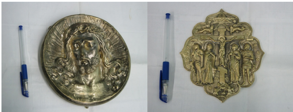
Рис.6. Отливки выполненные по технологии с дуплексным отверждением ЭТС.
