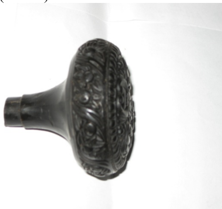
Рис.5. Выплавляемая модель с укороченной цилиндрической частью.
