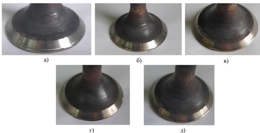
Рисунок 4 – Восстановленный клапан при стендовых исследованиях. а) после 1-го контрольного замера; б) после 2-го контрольного замера; в) после 3-го контрольного замера; г) после 4-го контрольного замера; д) после 5-го контрольного замера;
