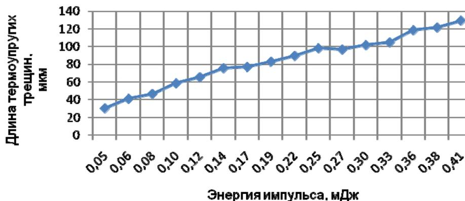
График 1 Зависимость размера термоупругих трещин от вводимой энергии импульса
