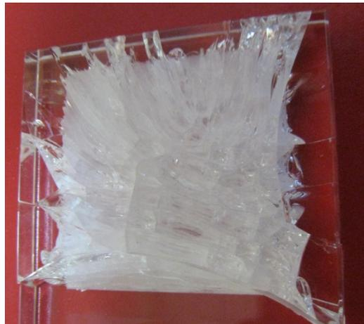
Рис. 4 Результат критического уменьшения расстояния между соседними дефектами
