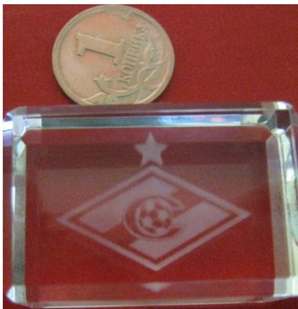
Рис.7 Вид изображения, выполненного на лазере нового поколения (10 слоев)
