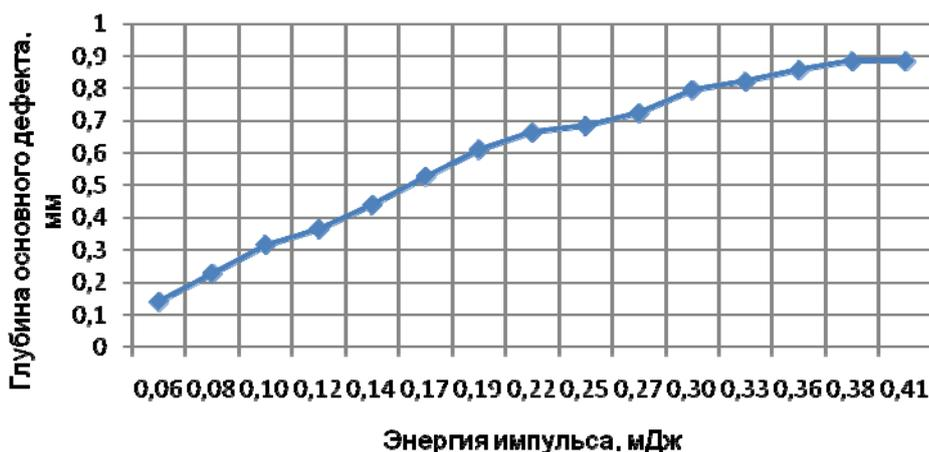
График 2 Влияние энергии импульса на глубину получаемого дефекта
