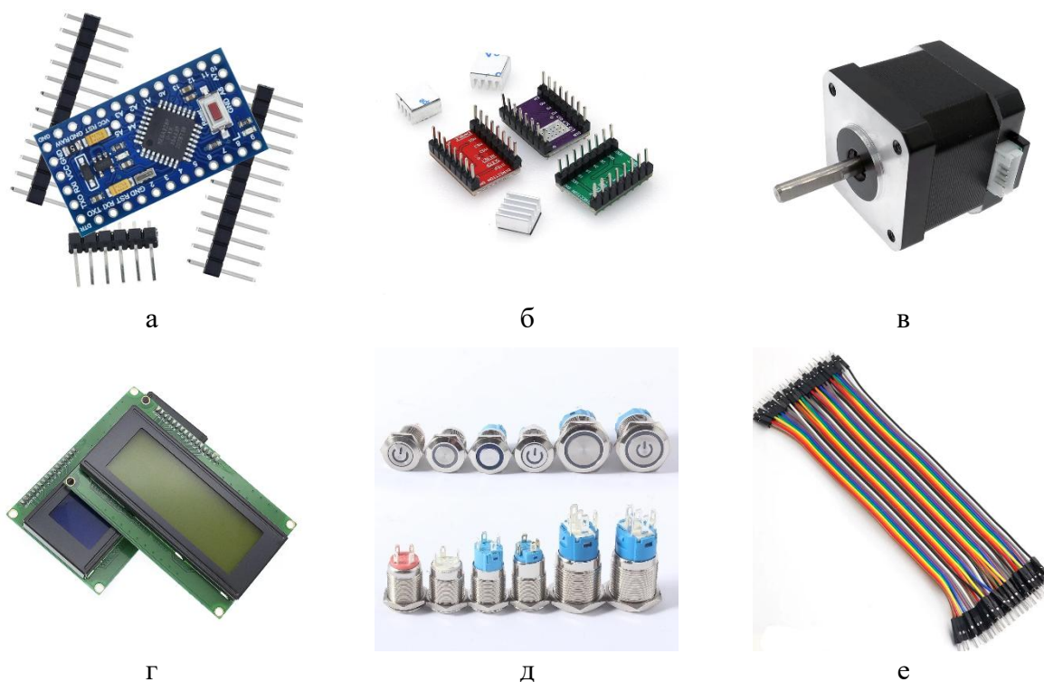
а – микроконтроллер; б – драйвер; в – шаговый двигатель; г – LCD-экран; д – кнопки; е – джамперы Рисунок 2 – Комплектующие для сборки системы
