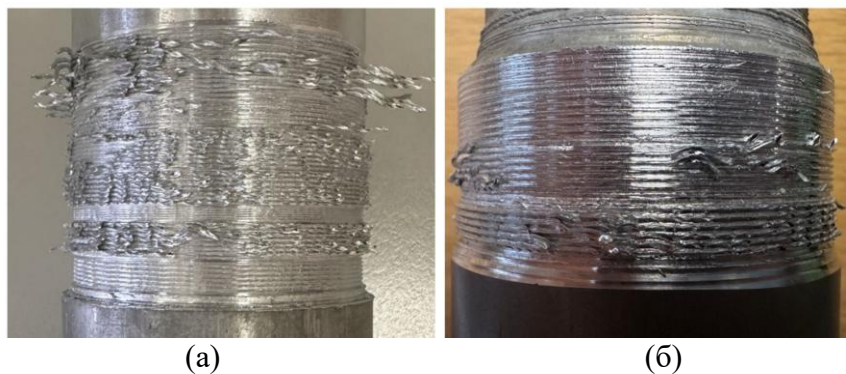
Рис. 3. Макроструктура сплава Д16 после отжига, закалки и ДР с разными скоростями а) v=50\text{м/мин} ; б) v=10\text{м/мин}
