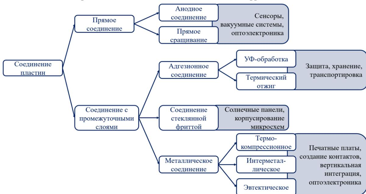
Рис. 1. Классификация методов соединения пластин
