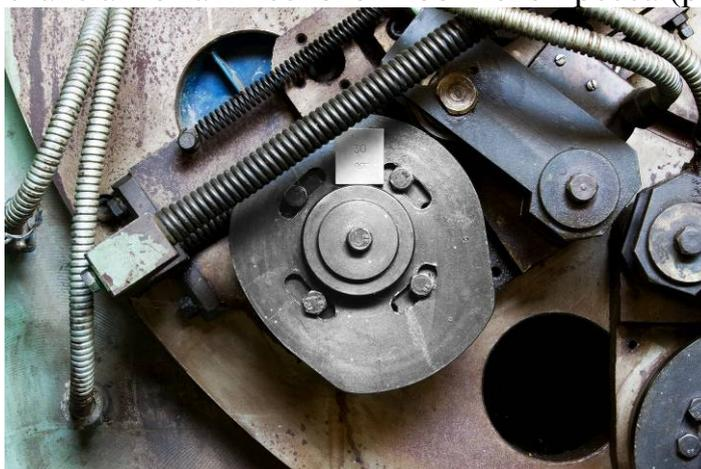
Рис. 1 Фотоснимок плоского кулачка с установленной мерой.
