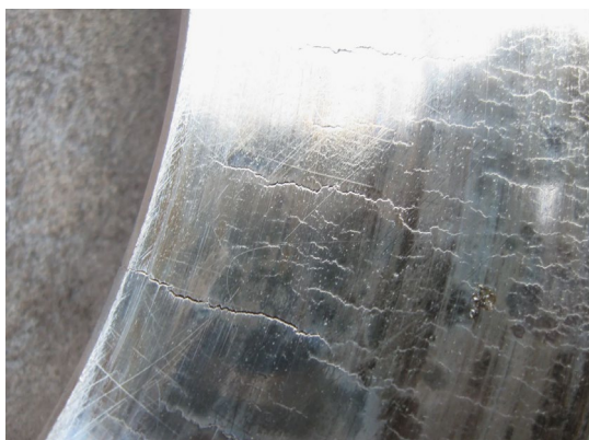
Рис. 1. Образование шлифовальных трещин и «прижогов».
