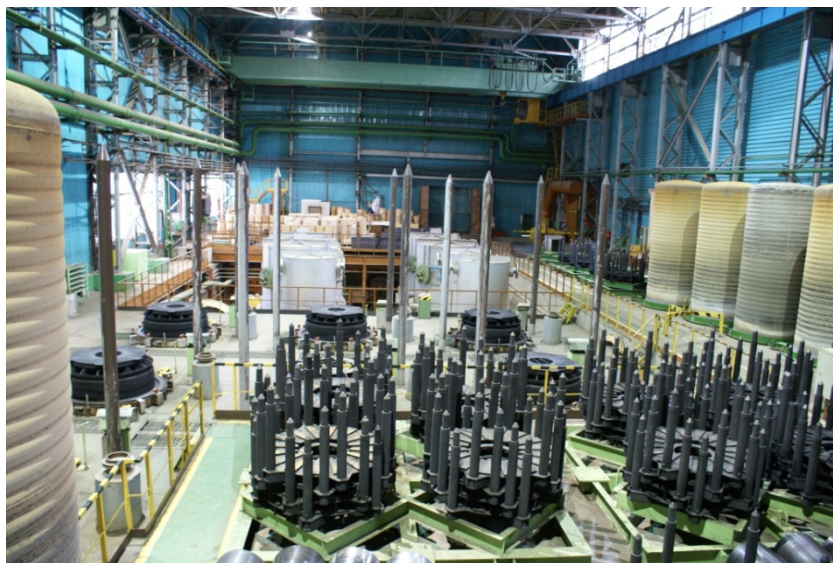
Рис. 5. Колпаковые печи для отжига плотномотанных рулонов
