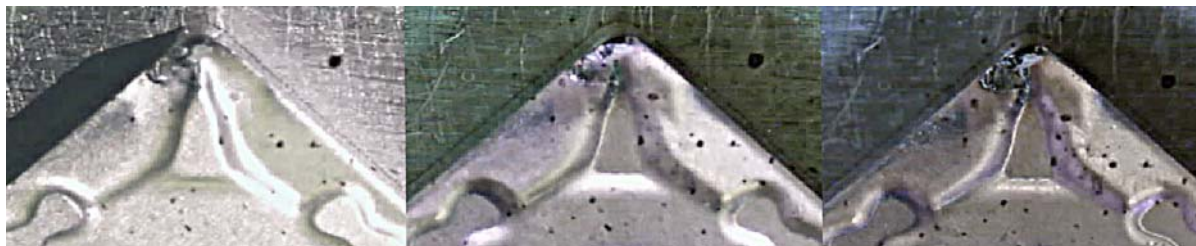
Рис. 3. Фотографии передней кромки ВК6+(Ti,Si,Al)N, слева направо: 135 м, 289 м 436 м
