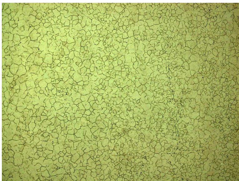
Рис. 5. Микроструктура стали ВКС-180ИЛ после цикла закалок: 1020 °С, 1 ч, вода + 3 раза 940 ± 10 °С, 1ч, вода
