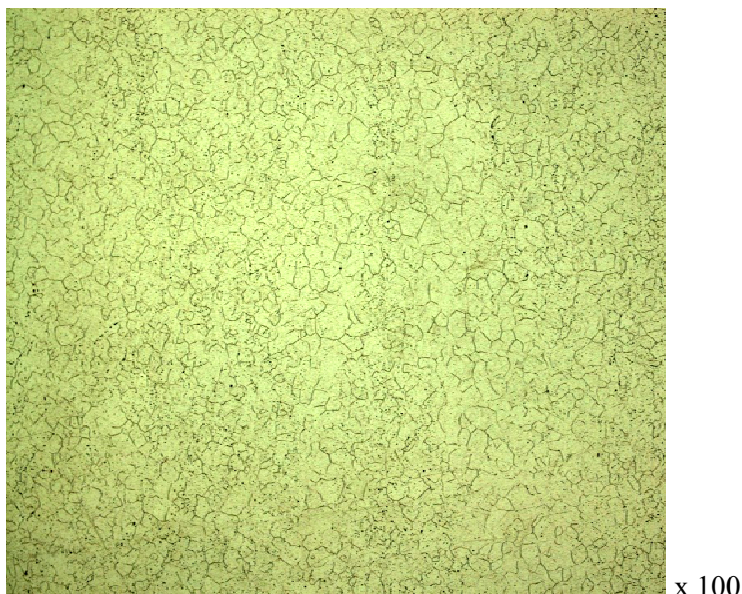
Рис. 8. Микроструктура стали ВКС-180ИЛ после цикла закалок: 1100 °С, 1 ч, вода + 3 раза (940 ± 10) °С, 1ч, вода
