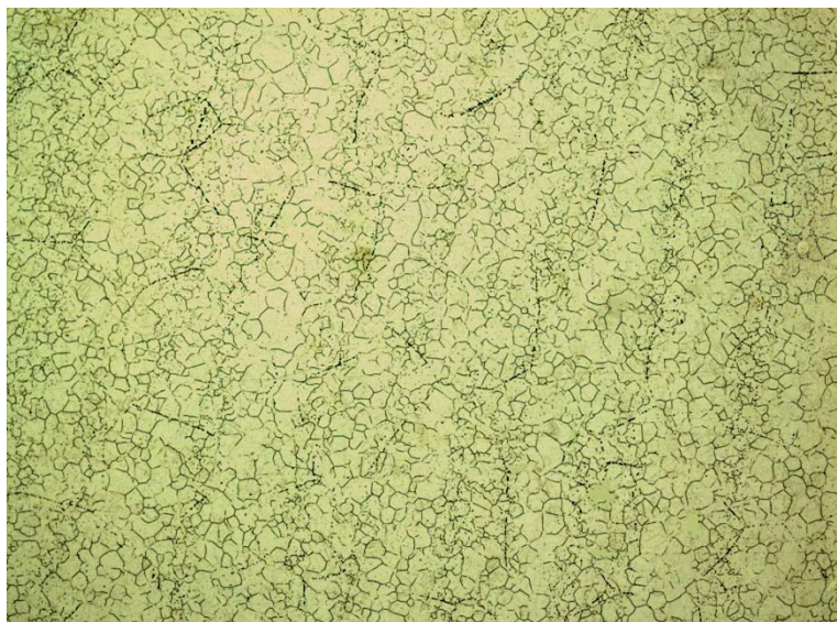
Рис. 4. Микроструктура стали ВКС-180ИЛ после цикла закалок: 1000 °С, 1 ч, вода + 3 раза 940 ± 10 °С, 1ч, вода
