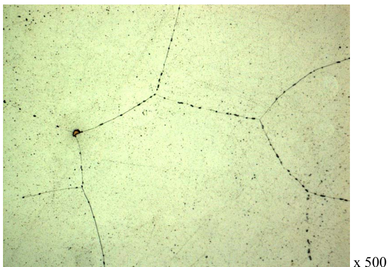
Рис. 1. Мартенситностареющая сталь. Охрупченное состояние
