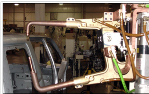
Рис. 4. Точечная сварка металла
