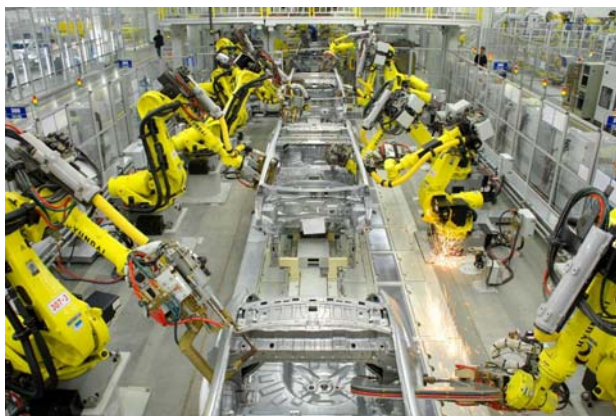
Рис. 1. Сварка на конвейере Hyundai Solaryis
