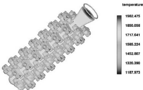
Рис. 2. Распределение температуры в конце заливки
