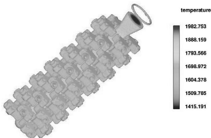
Рис. 10. Распределение температур по объему модельного блока в конце заливки
