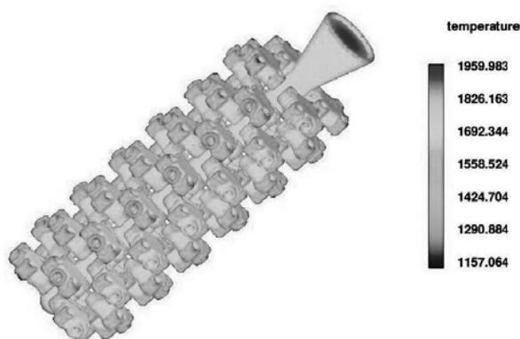
Рис. 4. Распределение температур по объему модельного блока в конце заливки
