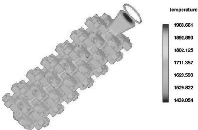
Рис. 8. Распределение температур по объему модельного блока в конце заливки
