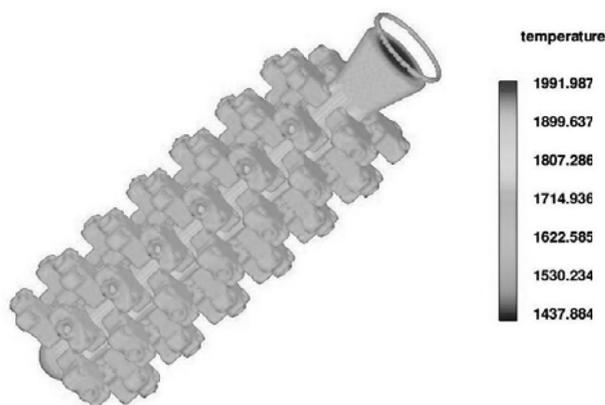
Рис. 6. Распределение температур по объему модельного блока в конце заливки
