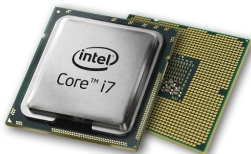
Рис. 6. Пример компонента с матричным расположением выводов (кол-во выводов ~1600)
