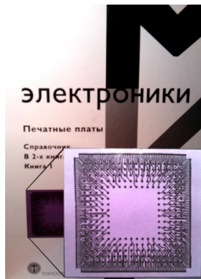
Рис. 5. Пример предельно возможной односторонней разводки BGA компонента
