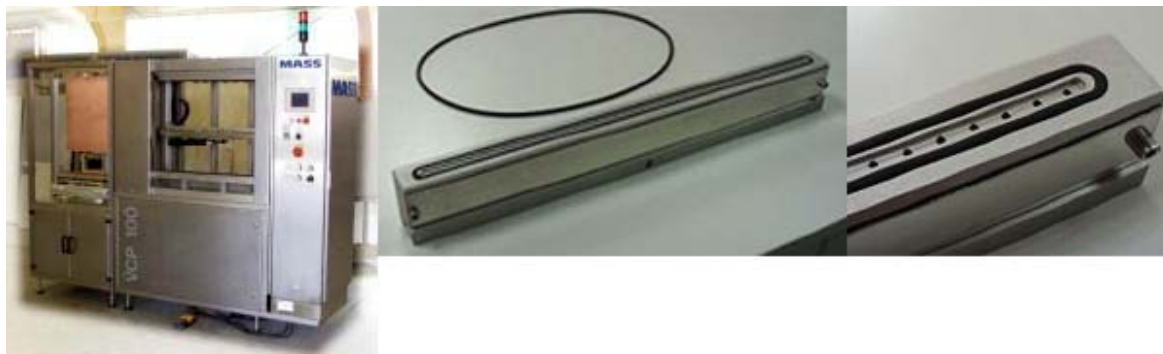
Рис. 13. Слева - Общий вид немецкой установки «MASS GmbH Via-Hole Filling System», справа – картридж
