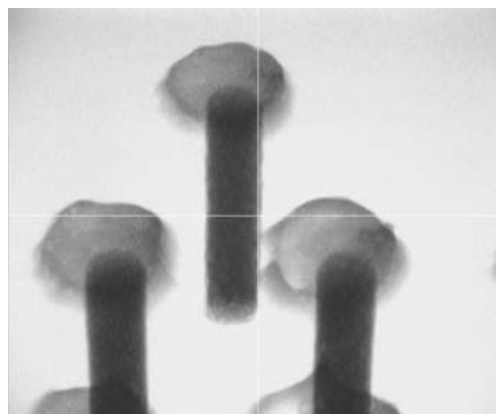
Рис. 10. Рентгеновский снимок: Слева – результат ручного заполнения; Справа – результат заполнения оборудованием. Метод заполнения через шаблон
