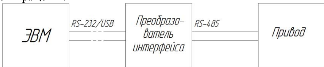
Рис.1. Схема подключения привода к ЭВМ
