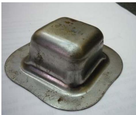
Рис. 1. Деталь коробчатой формы
