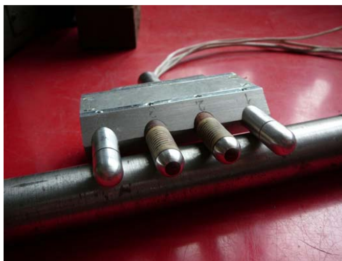
Рис. 5. Устройство для измерения параметров торможения в импульсных гиперзвуковых потоках
