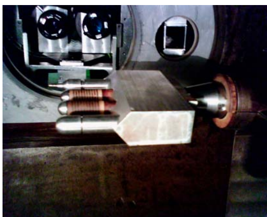
Рис. 1. Устройство для измерения параметров торможения в импульсных гиперзвуковых потоках, размещенное в рабочей части ударной трубы УТ-1М
