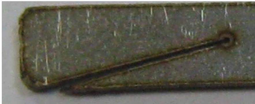
Рис. 6. Образец с наилучшим качеством реза (№15). Вид с обратной стороны.
