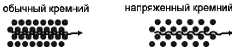
Рис. 6. Путь электрона сквозь обычный и напряженный кремний
