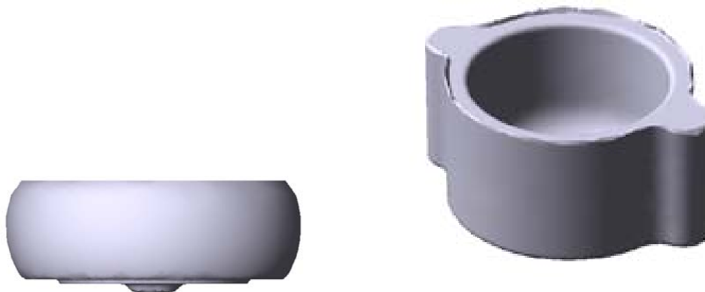
Рис. 2. Технологический процесс получения поковки (1-осадка, 2-штамповка, 3-прошивка отверстия)
