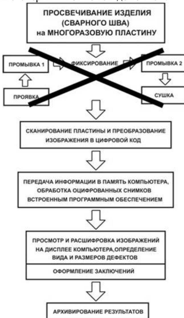
Рис. 1. Схема контроля с использованием фосфорных пластин
