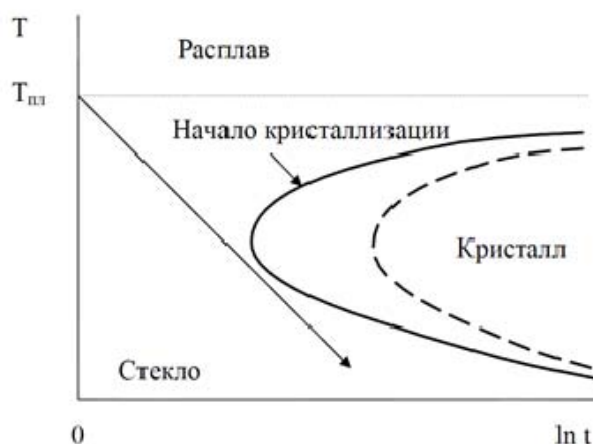
Рис.1. Кинетическая диаграмма получения аморфного металлического сплава путем закалки из жидкого состояния.
