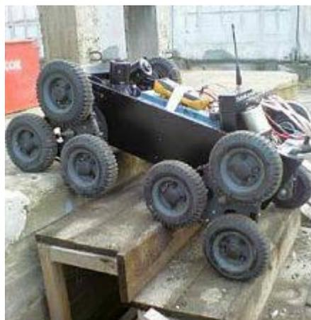
Рис. 5. Трёхколесная система для преодоления препятствий
