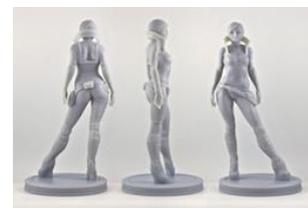
Однако, прототипы - это еще не все. Следующая ступень - **быстрое производство**. Уже сейчас некоторые технологии 3D-печати позволяют изготавливать готовые предметы из различных материалов. Это идеальное решение для мелкосерийного производства, поскольку унифицированный техпроцесс дает возможность сделать деталь любой конфигурации за относительно малое время.
