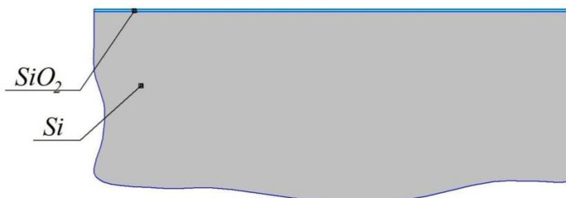
Рис. 3. Термическое окисление кремния
