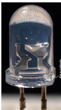
Рис. 2. Светодиод с пластиковым оболочкой-корпусом.
