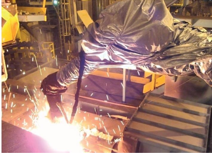
Рис.6 Измерение температуры, МНЛЗ №3 компании UsiminasCubatao, Бразилия
