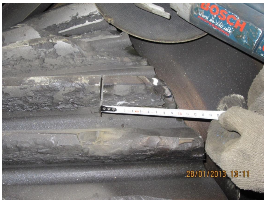
Рис 2. Изъятие образца зуба полушеврона вал-шестерни
