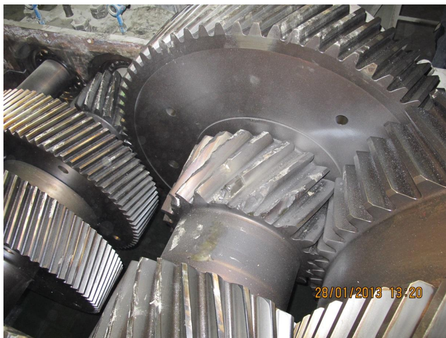
Рис.1. Повреждения шестерни редуктора.
