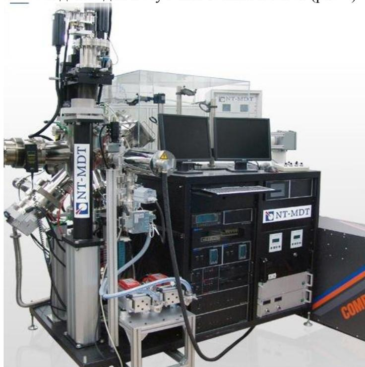
Рис.9. Платформа Нанофаб-100, модуль импульсного лазерного осаждения
