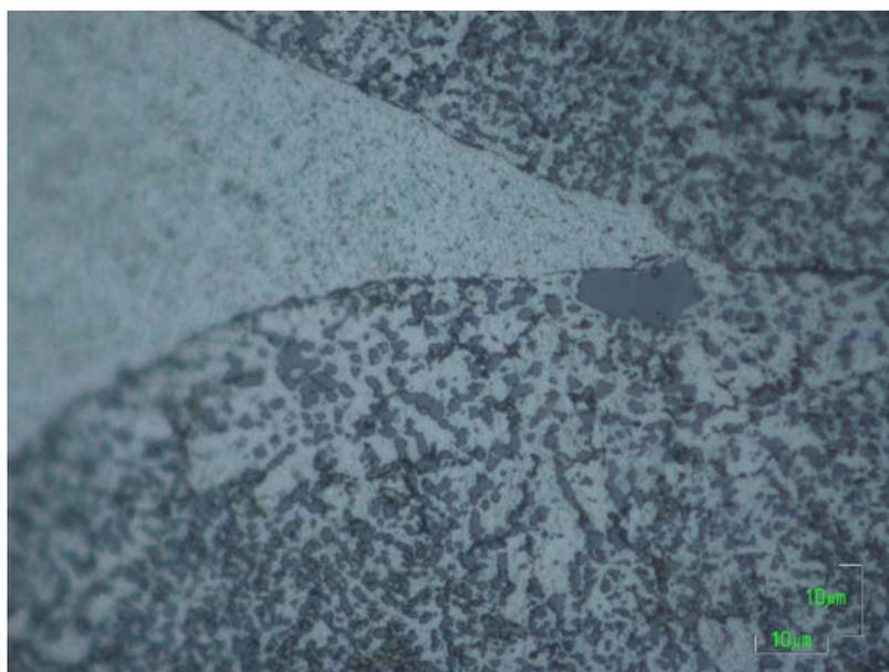
Рис. 6 Микроструктура брикета (70%1379+30%АД0) после РКУ прессования,  $t=500^{\circ}\text{C}$ , 1 проход, увел. 1000
