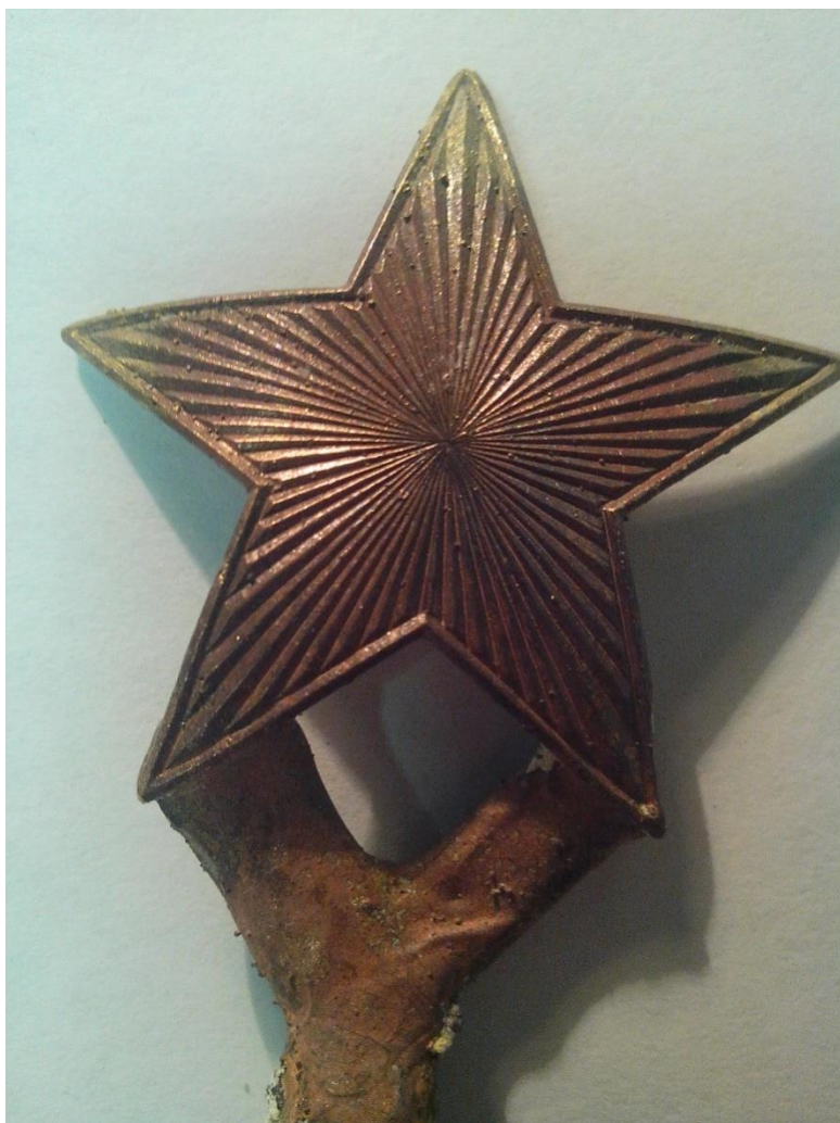
Рис.4 Контрольная отливка «звездочка» из сплава ЛЦ40С (состав №1 таблица 1)
