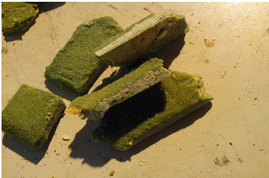
Рис. 3 Образцы оболочки, нанесенные на пластину из модельного состава.
