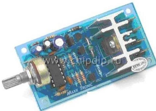
Рис. 13. Регулятор мощности (MP303F)
