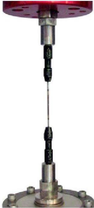
Рис. 6 – Испытательная система для тонких проволок Instron [3]
