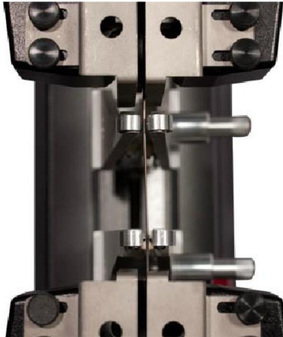
Рис. 7. Автоматический экстензометр AutoX 750 [4]
