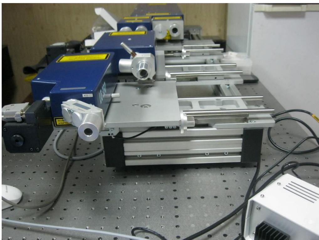
Рисунок 2. Nd:YAG-лазер, используемый для эксперимента по абляции.
