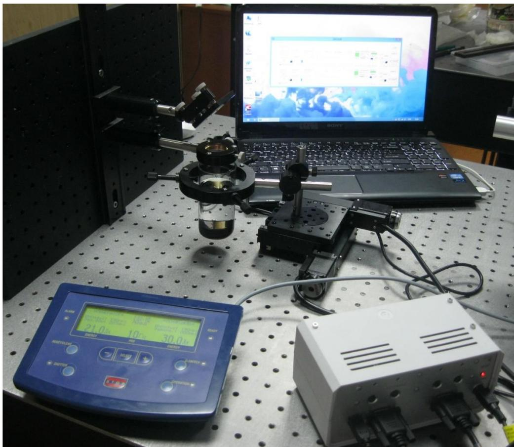
Рисунок 1. Установка для абляции металлической мишени в жидкости.
