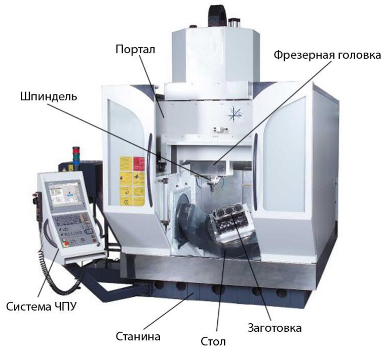
Рис.4. Узлы фрезерного станка
