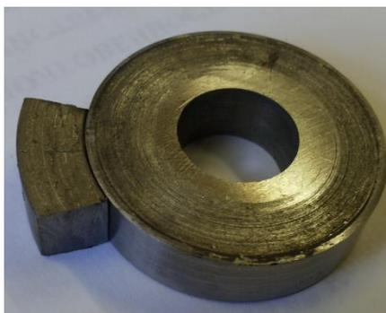
Рис. 3. Образец для износных испытаний «ролик-колодка».
